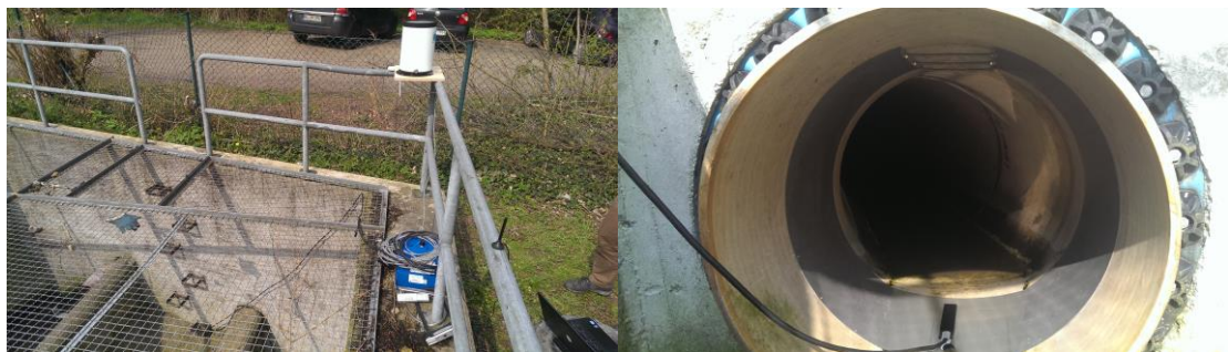
Abbildung 14: Niederschlagsmesser (links) und Sonde (rechts) an der Regenwasserhaltung in St. Lorenz Süd (Fotos: S. Schlauß)
