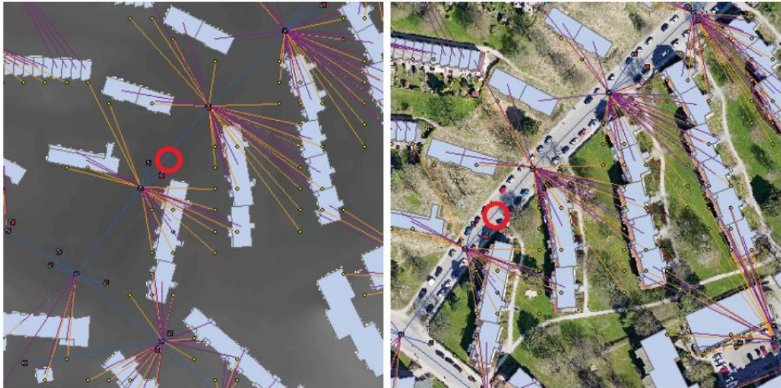
Abbildung 13: Kontrollpunkt für die Prüfung der Modellkopplung. Laser-Scan-Daten (links, Landesamt für Vermessung und Geoinformation SH) und Orthophoto (rechts, EBL)
